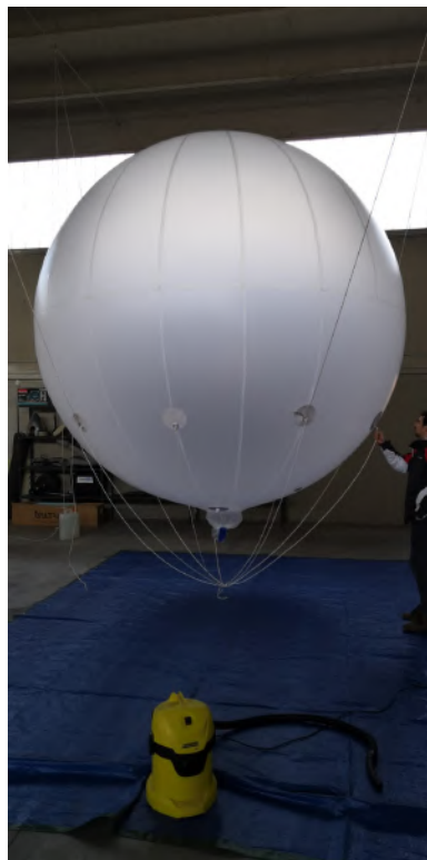
Figura 3.5: Test di gonfiaggio effettuato con aria
