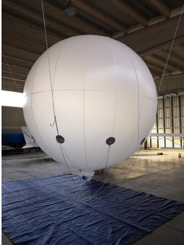
Figura 2.4: Aeronord SF3.5- prova di gonfiaggio effettuata in hangar
