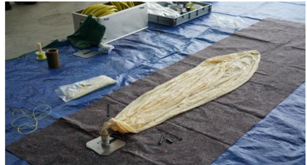
Figura 3.6: Bombola elio e disposizione del pallone prima di iniziare il gonfiaggio
