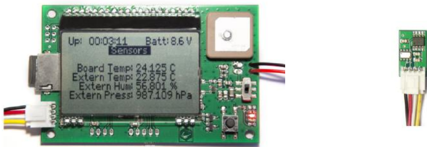
Figura 5.1: Datalogger Strato3, a destra il sensore esterno
